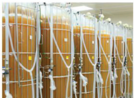
شکل ۳-۱۰: بیوراکتورهای افقی کشت سلولی و تولید انبوه متابولیت ثانویه گیاهی
