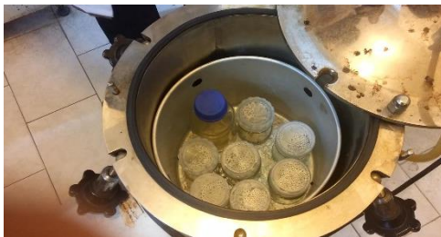
شکل ۸- اتوکلاو کردن محیط کشت
