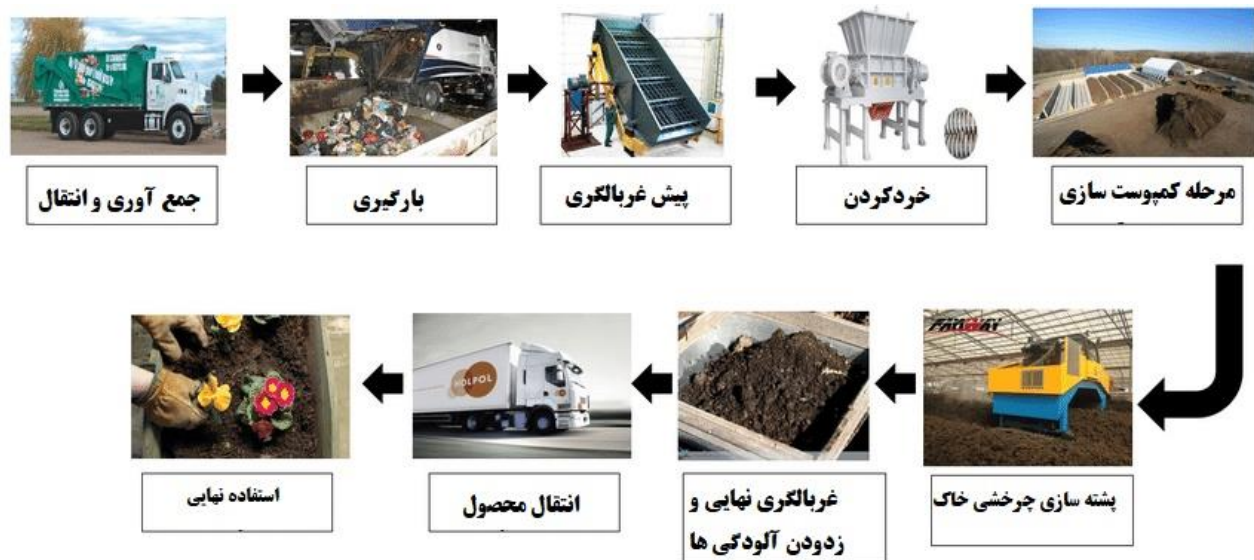
شکل شماره ۱۳. کمپوست سازی و تصفیه خاک به روش بادگیری یا پشته سازی
